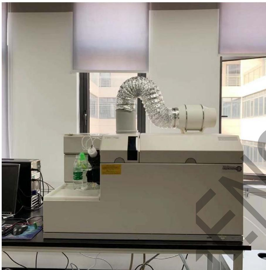
AGILENT 7500 电感耦合等离子体质谱 - ICP-MS, 是一种新型的无机元素和同位素分析技术, 可快速同时检测周期表上几乎所有元素。ICP-MS技术在分析能力上, 超过传统的无机分析技术如电感耦合等离子体光谱技术(ICPAES)、石墨炉原子吸收(GFAAS)和汞冷原子吸收技术(CVAAS)的总和。
