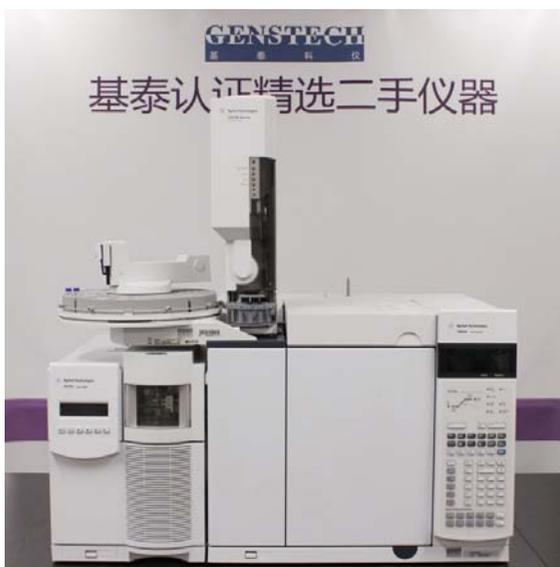
Agilent 7890-5975C气质联用系统是第一个具有安捷伦独一无二的微量离子检测功能的气-质联用仪，此功能明显降低噪音水平，提高峰形和质谱的可信度，使得系统可以精确，快速和容易地分析复杂样品，同时也扩展了简单样品的可靠性。除了独一无二的微板流控技术带来的优点之外，安捷伦还将快速转换装置(QuickSwap)用于5975C气质联用仪，因此无需放真空就可以更换色谱柱，节约了大量时间。
