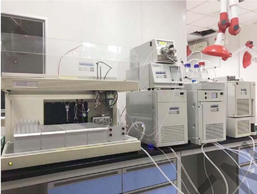
WATERS半制备级纯化是指每次纯化作业有几毫克到几十毫克级别的化合物产出，适用于制备大量产物的纯化，纯化作业可以依据紫外信号触发工作。
