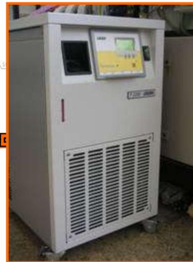
➤ 冷却薄膜可通过冷却辊及冷却循环系统来实现的，保证其快速冷却
