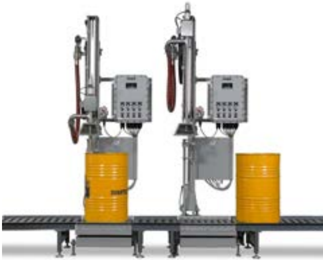
GZM-200EX防爆型200升液面下双头灌装机
